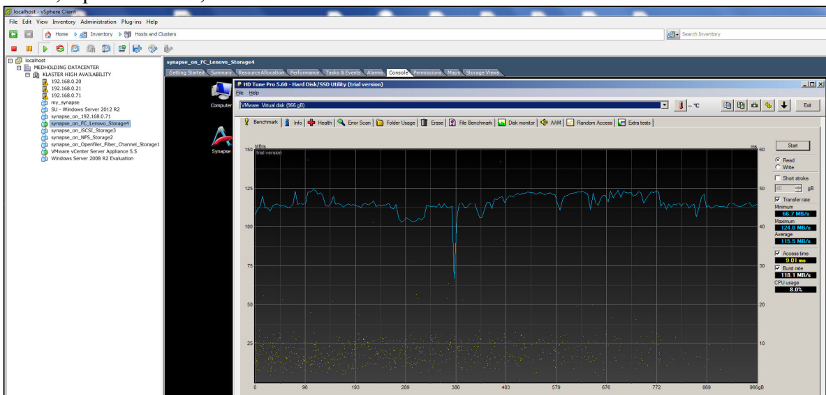
Rys. 42. Prędkość odczytu heterogenicznego dysku wirtualnego alokowanego w pamięci masowej Lenovo Storage, rozpostartego w zbiorze pamięci masowych Openfiler ESA, iSCSI, NFS. Przeciętna prędkość odczytu: 115,5 MB/s
